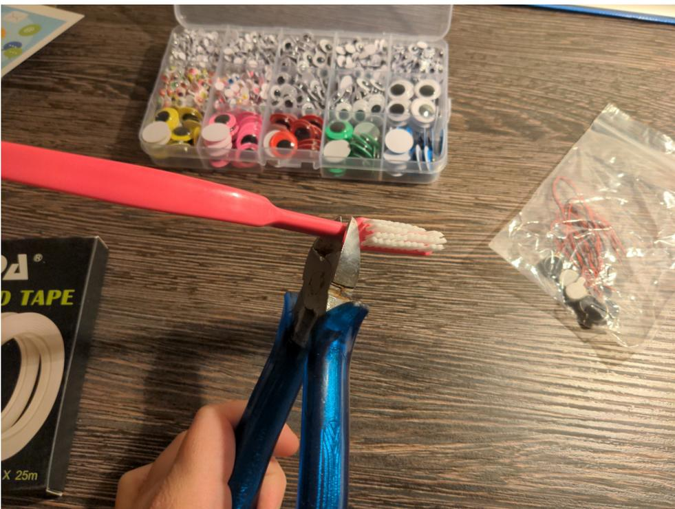
Den Bürstenkopf mit einer Kneifzange abtrennen. Die eventuell etwas scharfen Kanten können anschließend vorsichtig mit einem Cuttermesser oder einer Feile abgerundet werden.
